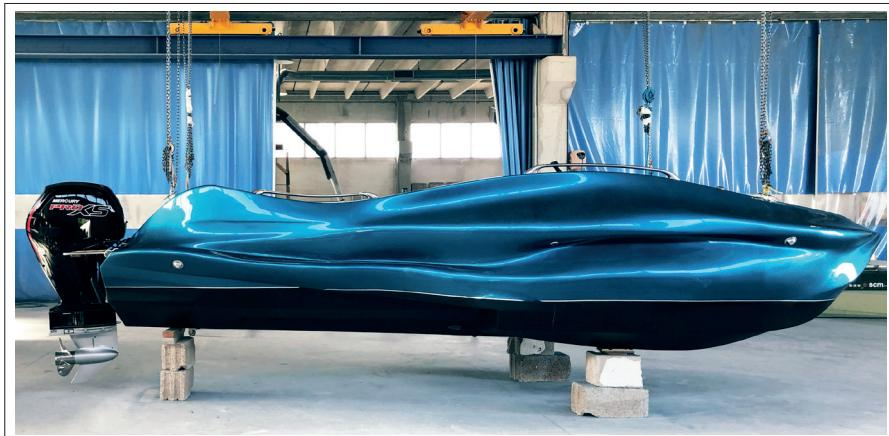
MAMBO (Motor Additive Manufacturing BOat), ha una lunghezza di 6,5 metri, baglio massimo di 2.5 metri, peso 800 kg ed è equipaggiata con uno scattante fuoribordo da 115 cv.
